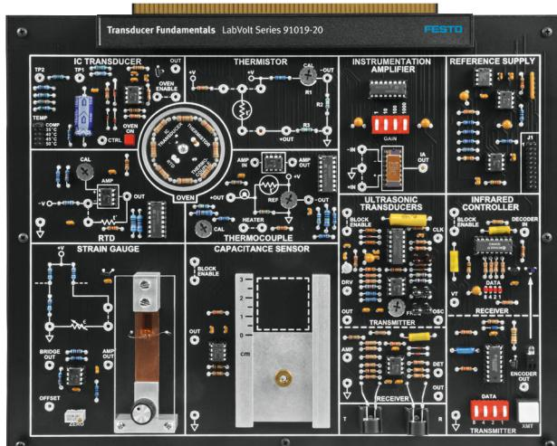
传感器基础知识课程可引导学员了解用于连接计算机和控制电路的电气和器件。学员将学习输入和输出传感器的原理，以及如何将物理量（例如热、位置、接近度和力）转换为电信号来进行检测和处理。
