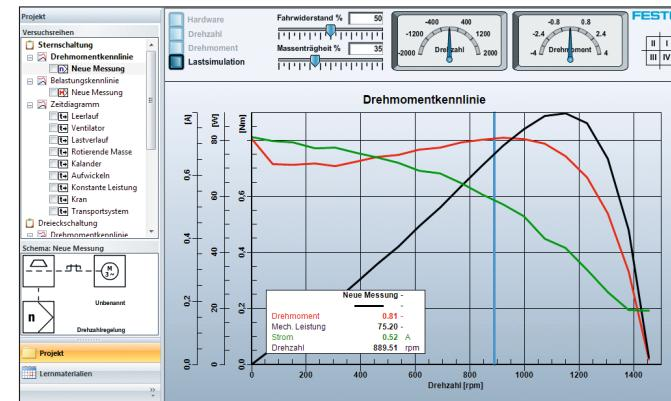
DriveLab 软件易于操作且直观易懂, 支持自动记录机器特性曲线、进行静态负载参数设置以及负载模型仿真, 以便在实际条件下检测驱动器。可以通过项目练习对不同的驱动概念进行比较和优化。示例配置提供了易于理解的简单介绍。
