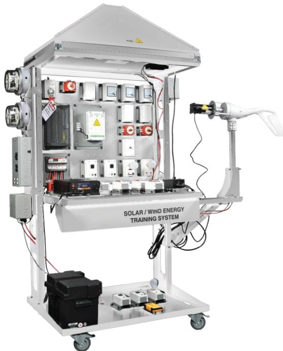
太阳能/风能培训系统是一个完整的混合能源培训系统。该模块化课程涵盖替代能源系统的历史、基础知识、安装、操作、维护和服务。它符合高中生和大学生的需求。
