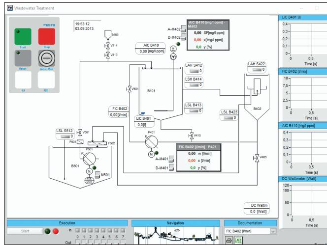
FluidLab 水处理软件与 EasyPort 接口配合使用时，可方便地操作 EDS 水处理工作站，充当一个简易版的过程控制系统。
