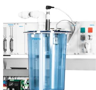
利用 P、PI 或 PID 控制算法，以演示和实践相结合的方式教授（闭环）控制技术。**温度**传感器 – 对于反应器工作站，使用 PT100 电阻温度计，这款温度计通过测量转换器来提供 0 到 10 V 的均一信号。借助加热器的连续可控性，控制器可设定额定温度并使其保持恒定。
