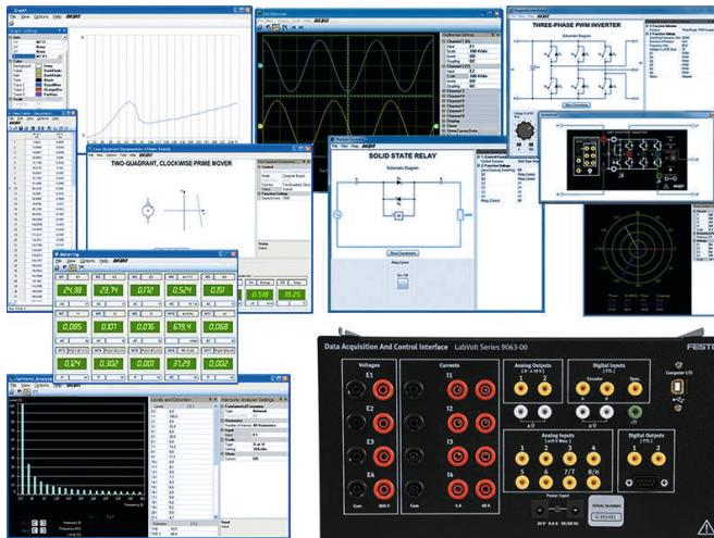
基于计算机的仪器取代了大量实际的数据采集设备：
